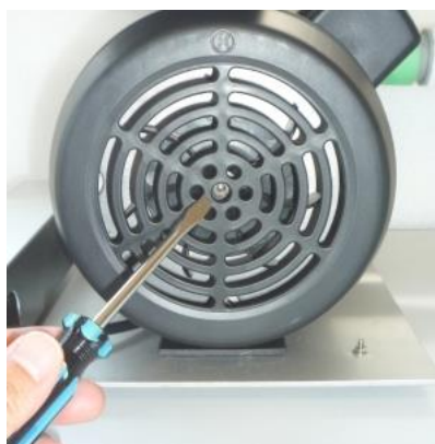
装置内部はこのようになっています。メンテナンス口よりマイナスドライバーを差し込み、中心部の窪みに合わせてください。
