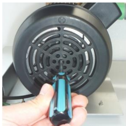
マイナスドライバーを時計回りに回し、インペラー部の固着をほぐしてください。
