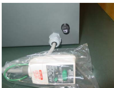
ほぐれましたら、ヒューズ交換口よりヒューズを交換し、運転を再開してください。
