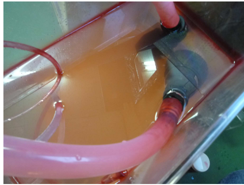
90 分後運転停止後、5 分経過した状況：やや薄いピンクの透明な液体となった。水温は常温から 45℃まで上昇した。
